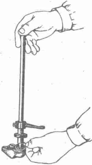
Bild 134. Einsetzen des Sicherungsrings für die Steins
