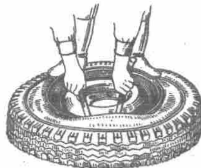
Bild 196. Abnehmen der äußeren Reifenwulst
