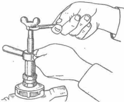
Bild 72. Abziehen des Flügelrades der Wasserpumpe
