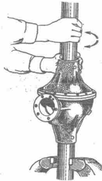
Bild 160. Einlaufen der Rollen der Ausgleichgetriebeleger
