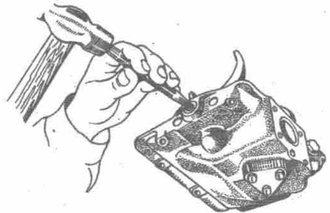
Bild 94. Entfernen der Blindflansche aus den Bohrungen für die Schaltschienen
