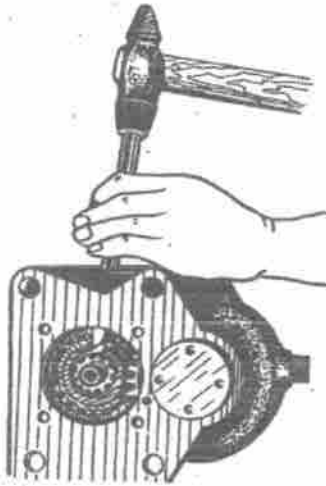
Bild 91. Herausnehmen des Sicherungsringes der Synchronisiereneinrichtung
