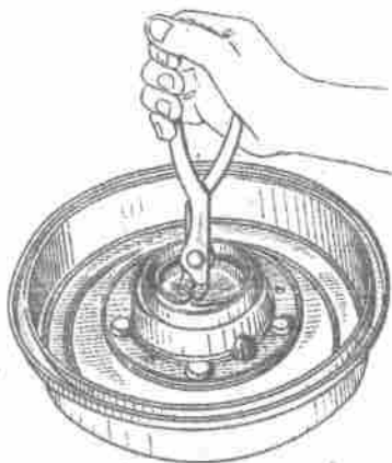
Bild 193. Entfernen des Sicherungsringes des inneren Radnabenlagers
