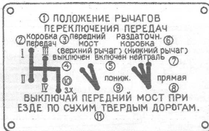
**Bild 9. Schild "Stellung der Gangschalthebel":**
